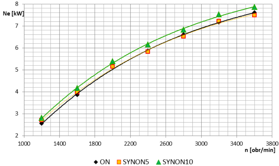
Rys. 3. Porównanie mocy efektywnej silnika AVL zasilanego mineralnym olejem napędowym, oraz mieszaninami oleju napędowego z syntetycznym olejem napędowym, pracującego przy pełnym obciążeniu
