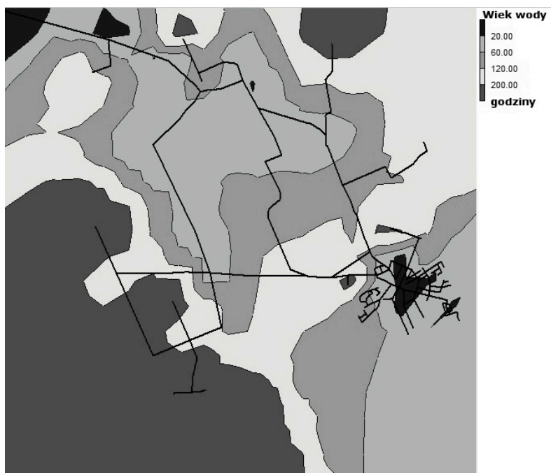
Rysunek 2. Wiek wody w badanej sieci wodociągowej w wariantcie 1, symulacja 240 h
