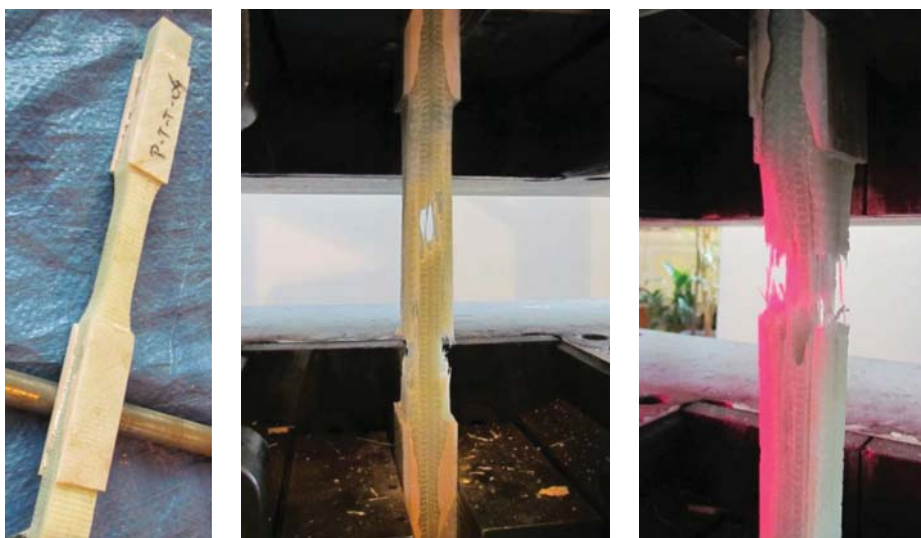
Rys. 9. Od lewej: widok przykładowej próbki wielowarstwowej o tzw. kształtce wiórkowej oraz różne postacie zniszczenia próbek wielowarstwowych
