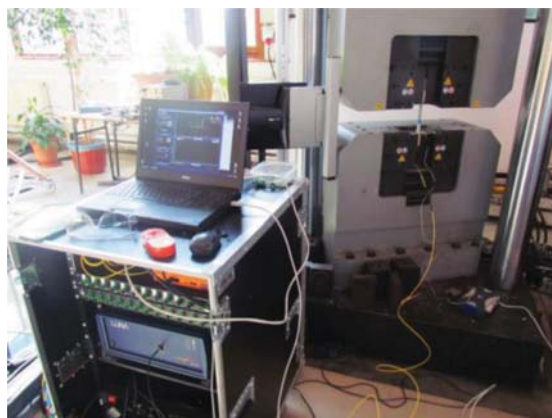
Rys. 6. Po lewej: wizualizacja przestrzenna tras pomiarowych światłowodu zainstalowanego wewnątrz próbek oraz na ich powierzchniach; po prawej: widok stanowiska do pomiarów światłowodowych w czasie badań osiowego rozciągania
