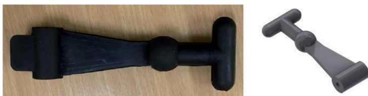
Rys. 15. Uchwyt mocujący: oryginał (z lewej), model wirtualny (z prawej)
