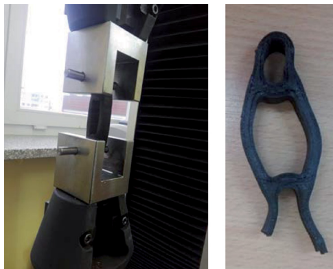
Rys. 21. Widok próbki (wieszaka tłumika) podczas badania (z lewej) oraz po badaniu (z prawej)
