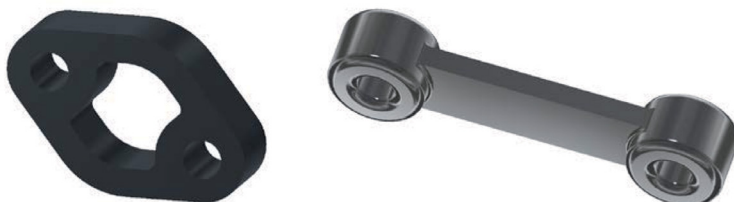
Rys. 19. Widok modeli badanych elementów. Wieszak (z lewej) oraz wodzik (z prawej)
