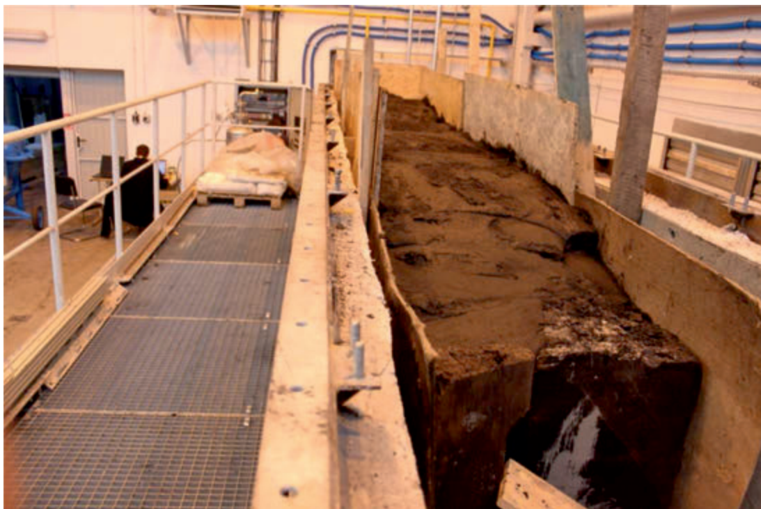
Rys. 1. Ułożenie bloków w reaktorze (fot. M Wiatowski)
