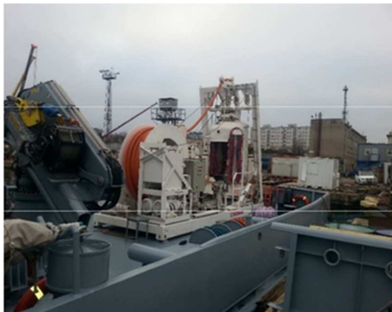
Rys. 2 Dzwon typu mokrego zainstalowany na rufie okrętu R14.
