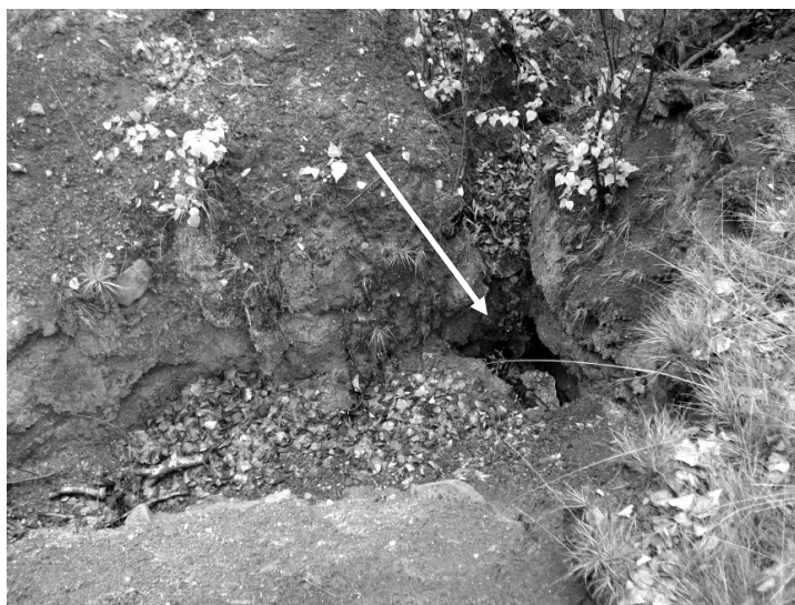
Rys. 8.4 Zapadliska tworzące się w zwałowisku żużli Zn-Pb w Rudzie Śląskiej
