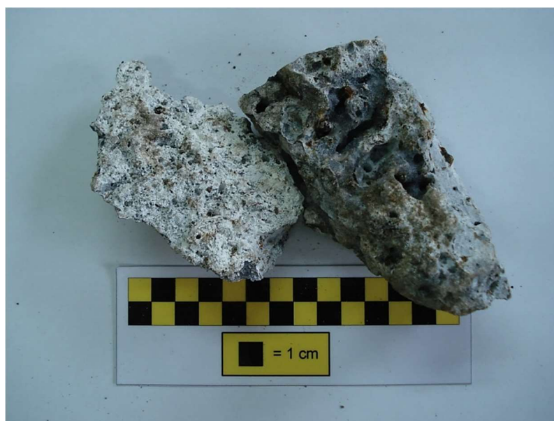
Rys. 8.6 Żuźle stalownicze pokryte białym nalotem minerałów wtórnych
