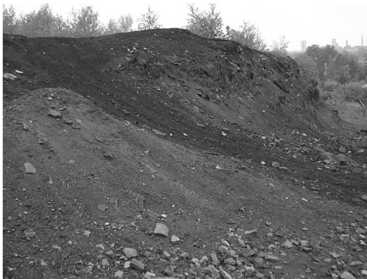
Rys. 8.5 Zwiędnięta partia żużli Zn-Pb na zwałowisku w Rudzie Śląskiej
