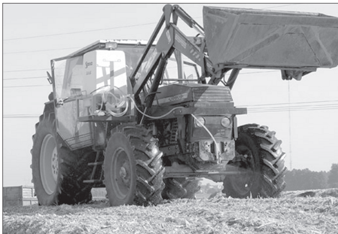
Rys. 3. Dozowanie melasy w czasie formowania przyzmy kiszonki [SANO, 2014]
