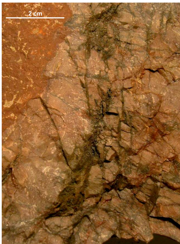
Ryc. 14. Żyłki siarczków żelaza w dolomicie w strefie uskokuwej; Budy Fig. 14. Iron sulphide veinlets in dolomite within the fault zone; Budy quarry
