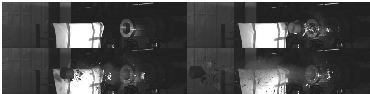
Rys. 12. Wylot pocisku podkalibrowego z urządzenia wylotowego (czas naświetlania 20 \mu s, prędkość rejestracji 18000 klatek na sekundę)
