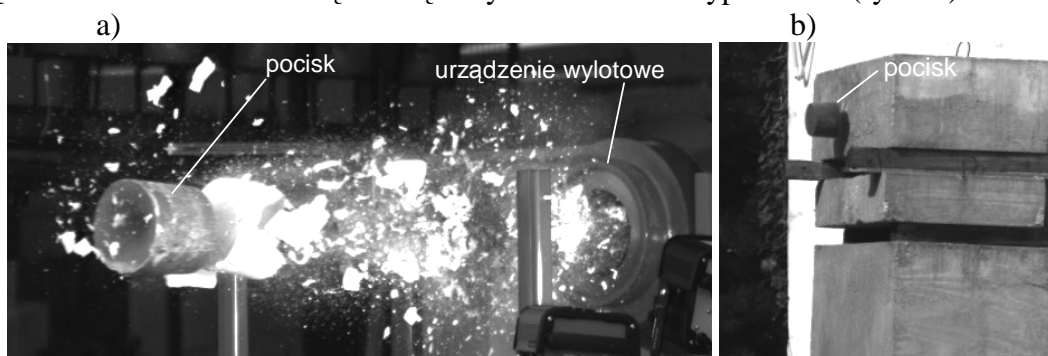
Rys. 15. Badania sabota, w którym pocisk znajduje się na czole ładunku: a) uwolnienie pocisku podkalibrowego z sabota (widoczne liczne i duże fragmenty wypełniacza - czas naświetlania 40 \mu s, prędkość rejestracji 8000 klatek na sekundę), b) dołot pocisku podkalibrowego do kulochwytu (czas naświetlania 60 \mu s, prędkość rejestracji 7500 klatek na sekundę),
