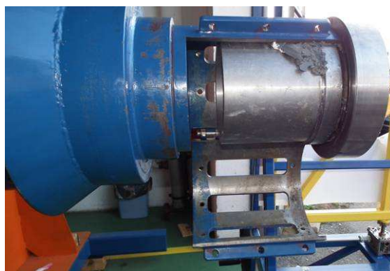
Rys. 11. Urządzenie wylotowe z otwartą pokrywą podczas usuwania pozostałości sabota.
