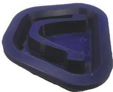
Rys. 3. Model stopy podporowej - wydruk 3D Fig. 3. Supporting base model – 3D print
