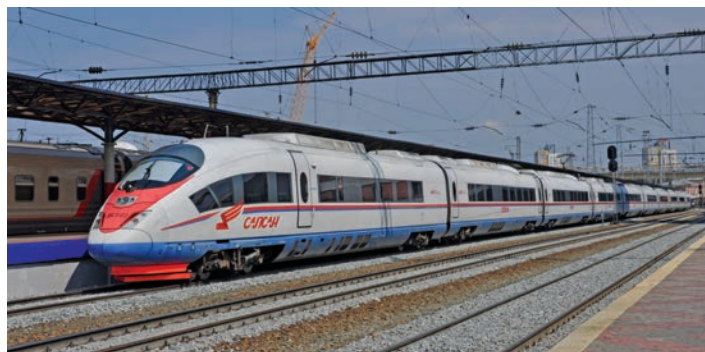
Dwusystemowy (3 kV DC; 25 kV 50 Hz) Sapsan serii ЭВС2–02 jako pociąg z Moskwy na stacji Niżny Nowogród (d. Gorki, napięcie w sieci 25 kV 50 Hz), Rosja (5.08.2012 r.) Fot. Marek Graff
