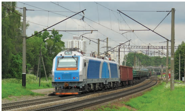
Dwuczłonowa БКГ1-002 (25 kV 50 Hz) została wyprodukowana w chińskiej fabryce w Zhouzhou na podstawie licencji Alstoma (seria jest wzorowana na rodzinie lokomotyw Prima I); ich przeznaczeniem będzie prowadzenie ciężkich i bardzo ciężkich pociągów towarowych na linii magistralnej BC – (Moskwa – Wiaźma –) Orsza – Mińsk – Brześć; na zdjęciu БКГ1-002 z pociągiem towarowym w okolicach Mińska, Białoruś (28.06.2012 r.) Fot. Sergej Badionkin
