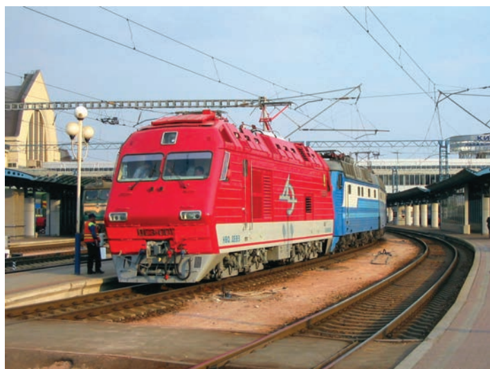
Seria DC3 (25 kV 50 Hz), wspólny produkt Siemens i wytwórni ukraińskich (DEWZ), to pierwsze lokomotywy z silnikami trójfazowymi na sieci UZ, na zdjęciu DC3-001 z pociągiem pasażerskim na stacji Kijów (24.04.2004 r.) Fot. Denis Iwanow
