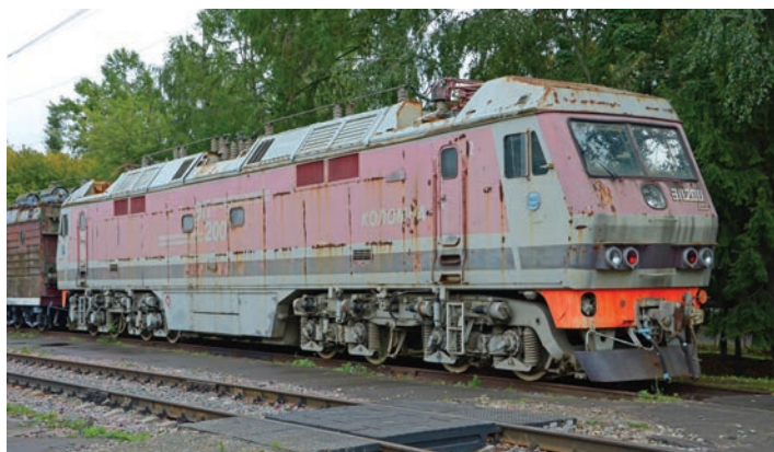
EP200 (25 kV 50 Hz) – niespełniona nadzieja SŽD; pojazd z nietypowym układem wózków – Do'Do', Szczerbinka, Rosja (9.09.2011 r.)
