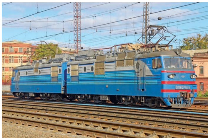
Seria ВЛ82 to jedna z nielicznych lokomotyw dwusystemowych na byłej sieci SZD; ВЛ82М-074 (UZ) pod napięciem 3 kV DC na stacji Charków, Ukraina (23.10.2011 r.)
