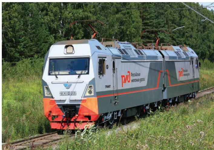
Współpraca Siemens i rosyjskich odpowiedników zaowocowała wyprodukowaniem lokomotyw towarowych serii 2ЭС10, zbudowanych w oparciu o serię 2ЭС6 (wspólna część mechaniczna), na zdjęciu 2ЭС10-002 na odcinku Chrusztalnaja – Siewierka, okolice Jekaterinburga, Rosja (9.04.2012 r.) Fot. Dmitrij Swiażyn
