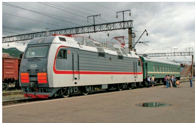
Seria 2ЭC5K (25 kV 50 Hz) to jedyna jednoczłonowa lokomotywa RЖД na napięcie 25 kV 50 Hz do obsługi lekkich pociągów towarowych i pasażerskich; na zdjęciu 2ЭC5K-015 z „pociągiem” podmiejskim relacji Kirienga – Lena na stacji końcowej, magistrala BAM, wschodnia Syberia, Rosja (6.07.2008 r.) Fot. Dmitrij Krieczetow
