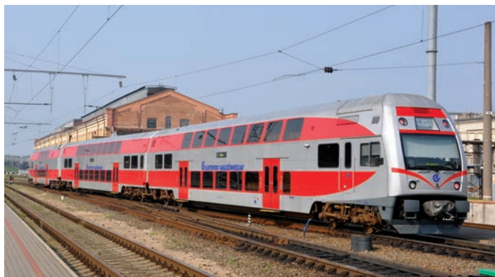
Najszerzego programu wymiany taboru, w tym zakupu nowoczesnych eozt dokonały koleje Litwy; na zdjęciu dwupoziomowy eozt (25 kV 50 Hz) produkcji Škody jako pociąg do Kowna opuszcza dworzec w Wilnie; podobne zespoły, ale w wersji dwusystemowej (3 kV DC; 25 kV 50 Hz), zakupiły koleje ukraińskie (16.08.2010 r.)
