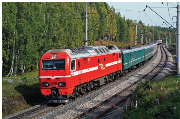
ЭП2К to pierwsza lokomotywa pasażerska na napięciu 3 kV DC w całości zaprojektowana i wyprodukowana w Rosji, która ma zastąpić serie 4С2 i 4С2Т; na zdjęciu ЭП2К-060 z pociągiem pasażerskim na odcinku Jekaterinburg-Sortirowocznoj – Siewierka, Rosja (6.09.2011 r.) Fot. Dmitrij Swiażyn
