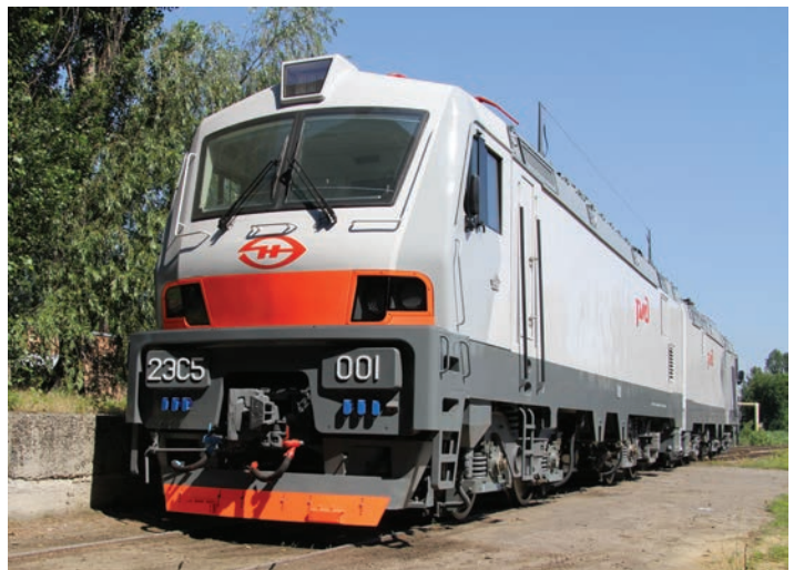
Wynik współpracy Alstom i NEWZ – dwusystemowa lokomotywa pasażerska serii ЭП20 (na zdjęciu ЭП20-001; napięcie w sieci 3 kV DC), wystawa „Expo 1520”, Szczerbinka pod Moskwą (9.09.2011 r.)
