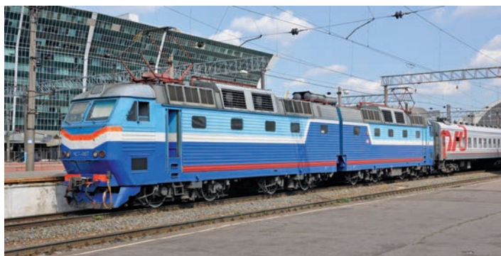
Škoda dostarczyła ponad trzy tysiące lokomotyw elektrycznych z rodziny 4C (na napięcie 3 kV DC i 25 kV 50 Hz) dla SŽD, używanych do dzisiaj w ruchu pasażerskim na sieciach kolejowych Rosji, Ukrainy czy Białorusi: 4C7-067 (3 kV DC) z pociągiem pasażerskim do ukraińskiego Doniecka podczas postoju na Dw. Kijowski w Moskwie (6.08.2012 r.) Fot. M. Graff
