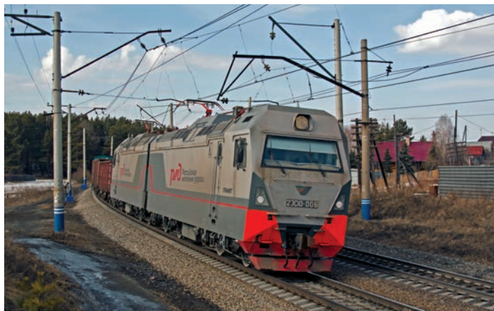
2ЭС10-006 „Granit” (3 kV DC) z ciężkim pociągiem (7000 t) na odcinku Jekaterinburg–Sortirowocznoj – Siewierka, Rosja (15.04.2011 r.) Fot. Dmitrij Swiażyn
