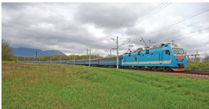
Seria ЭП1 (25 kV 50 Hz) to ostatnio podstawowy – wraz z ВЛ80 pojazd trakcyjny do obsługi ruchu pasażerskiego w azjatyckiej części Rosji na liniach zelektryfikowanych napięciem 25 kV 50 Hz; na zdjęciu ЭП1М–497 z pociągiem pasażerskim (z wagonami UZ) relacji Kijów – Adler, okolice Rostowa nad Donem, Rosja (24.04.2010 r.)
