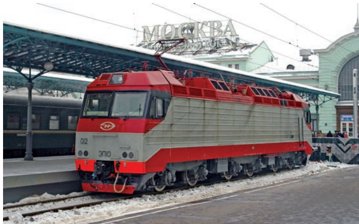
Dwusystemowa ЭП10-012 (napięcie w sieci – 3 kV DC), Dworzec Białoruski, Moskwa (18.02.2007 r.); pierwsza lokomotywa elektryczna z silnikami trójfazowymi dla RZD, zbudowana w kooperacji z Bombardierem Fot. Dmitrij Sawin
