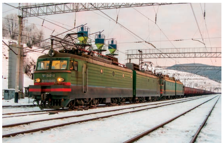
Dwie ВЛ11 (3 kV DC), w tym jedna nr 108 z pociągiem towarowym na stacji Ławocz- ne na linii magistralnej Lwów – Stryj – Czop, Ukraina (5.02.2010 r.) Fot. Leonid Andronow
