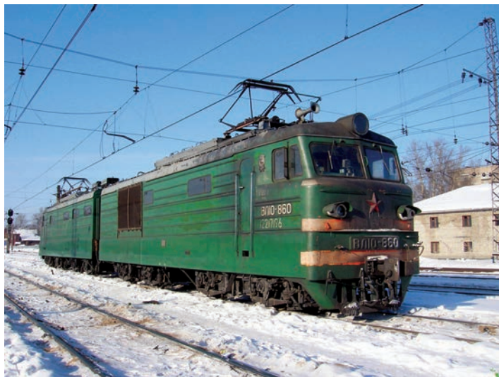
Serie ВЛ10 i ВЛ80 ze względu na deficyt lokomotyw pasażerskich na napięcie odpowiednio 3 kV DC i 25 kV 50 Hz na sieci SZD/RZD często były używane w ruchu pasażerskim, choć po ostatnich dostawach lokomotyw stan ten uległ zmianie; na zdjęciu lokomotywa ВЛ10-860 na stacji Jarostaw, Rosja (15.02.2006 r.)
