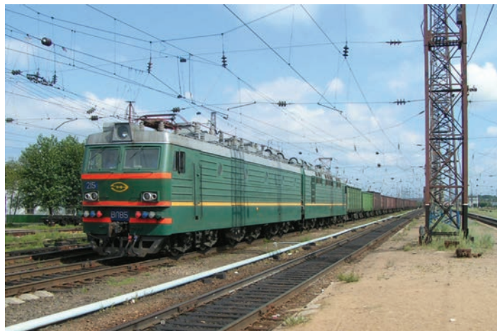
Na bazie lokomotyw towarowych serii ВЛ85 (25 kV 50 Hz) opracowano lokomotywy pasażerskie serii ВЛ65, a następnie ЭП1 (pojazdy na to samo napięcie); na zdjęciu ВЛ85-215 z pociągiem towarowym zmierzającym w kierunku zachodnim, mija stację Tajszet na magistrali transsyberyjskiej (4516 km), Rosja (30.07.2005 r.)
