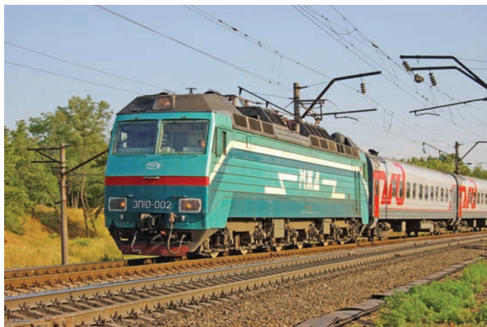
Dwusystemowa ЭП10-002 pos. pasażerskim (napięcie w sieci – 25 kV 50 Hz), okolice Rostowa nad Donem, Rosja (9.07.2009 r.) Fot. Wadim Anochin
