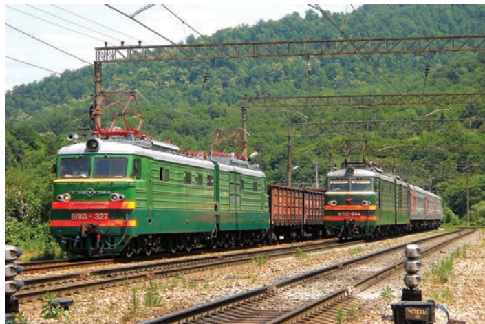
Seria ВЛ10 (3 kV DC) jeszcze na sieci SŽD była stosowana zarówno w ruchu pasażerskim, jaki i towarowym; ВЛ10-327 z pociągiem towarowym i ВЛ10-844 z pociągiem pasażerskim nr 461 relacji Ufa – Adler, stacja Grieczeskij, Kraj Krasnodarski, południowa część Rosji (18.06.2010 r.) Fot. Konstantin Chartamow
