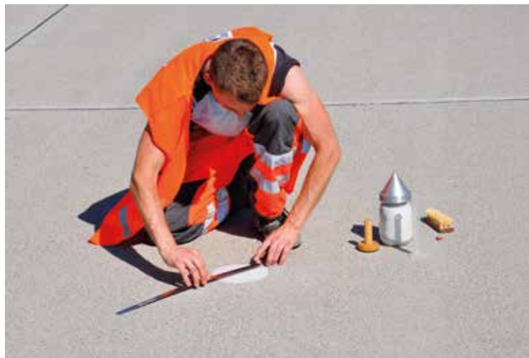
Rys. 1. Pomiar średniej głębokości makrotekstury powierzchni nawierzchni metodą objętościową z użyciem szklanych kulek [Źródło: Archiwum TPA]
