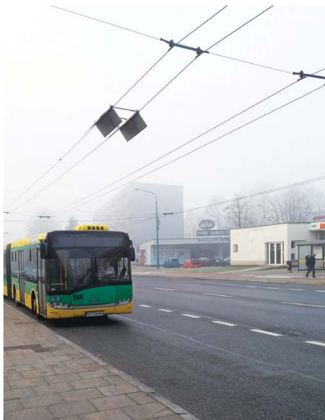
Fot. 1. Umieszczone na sieci trakcyjnej urządzenie wprowadzające palące odbieraki prądu na sieć trakcyjną (Tychy, 2017 r.). Fot. A. Molecki
