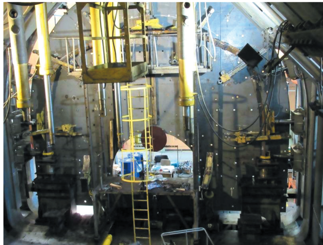
Rys. 12. Stanowisko badawcze z zainstalowanymi odrzwiami w trakcie badań
