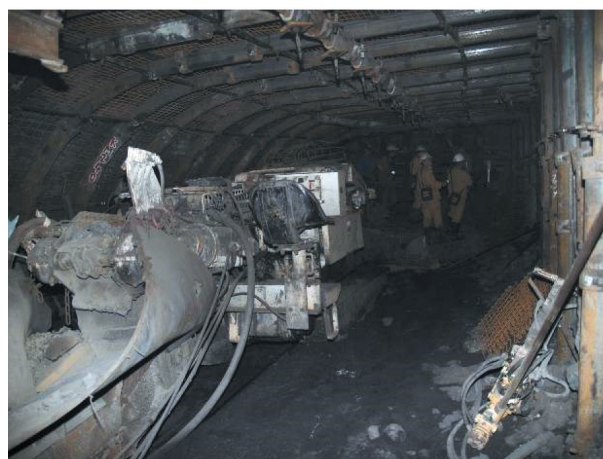
Rys. 20. Kanał likwidacyjny ściany zabezpieczony obudową ŁPro/B
