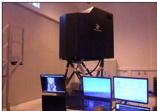
Fot. 1. Widok mobilnego symulatora lotu ETC-PZL wraz z podglądem czynności wykonywanych przez pilota na monitorze dodatkowego stanowiska kontrolnego [materiał ITWL/WSOSP, 2015]
