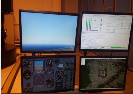
Fot. 2. Widok zobrazowania wirtualnego otoczenia statku powietrznego i przyrządów lotniczych prezentowanych pilotowi w mobilnym symulatorze lotu ETC-PZL oraz parametrów wytwarzanego w nim ruchu przestrzennego [materiał ITWLWSOSP, 2015]
