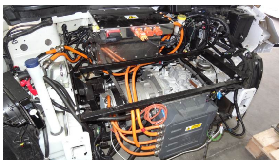
Rys. 1. Widok komory silnika samochodu Panda z napędem E-Kit. Z przodu widoczny jest falownik Sevcon Gen4Size8, za nim widoczne są silnik IPMSM i skrzynia biegów
