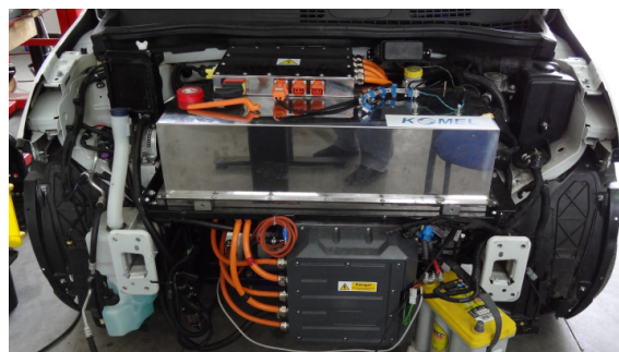
Rys. 2. Moduł baterijny firmy A123 z ogniwami pryzmatycznymi Li-ion nanofosfatowymi, zamontowany w komorze silnika nad silnikiem IPMSM i skrzynią biegów
