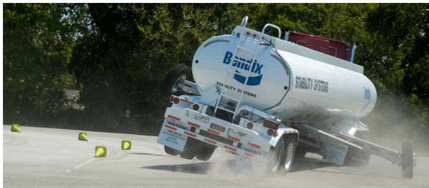
Rys. 1. Pojazd podczas badań stateczności ruchu
