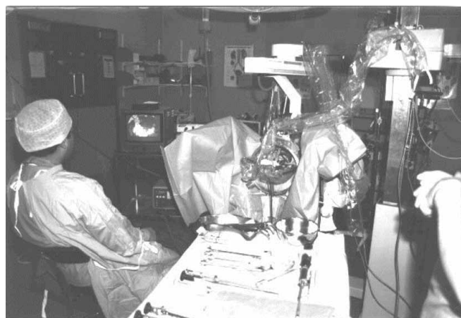
Rys. 6. Operacja prostaty wykonywana przez robota PROBOT. Chirurg jedynie nadzoruje przebieg operacji, którą robot wykonuje według wcześniej precyzyjnie ustalonego programu
