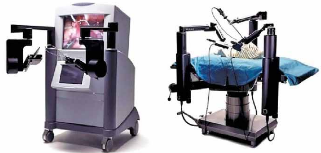
Rys. 11. Podstawowe elementy robota ZEUS: konsola chirurga (po lewej) oraz ramiona robota (po prawej)
