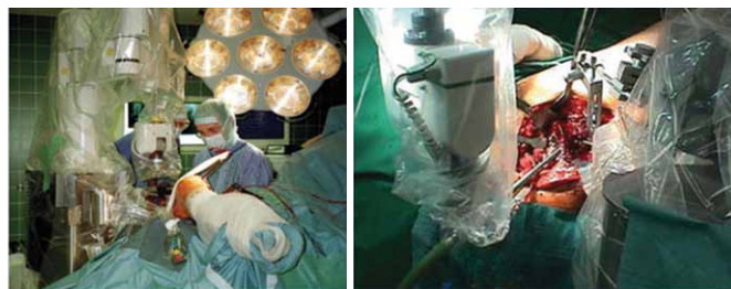
Rys. 9. Operacja ortopedyczna wykonywana z wykorzystaniem robota ROBODOC
