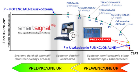
Rys. 4. Przydatność systemów nadzoru na rzecz detekcji zmian stanu technicznego na tle krzywej P-F
