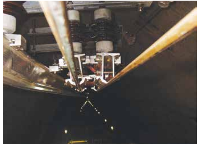
Fot. 3. Strefa przejściowa sieć łańcuchowa–sieć sztywna, widok z pomostu pociągu z fot. 1. Fot. W. Majewski
