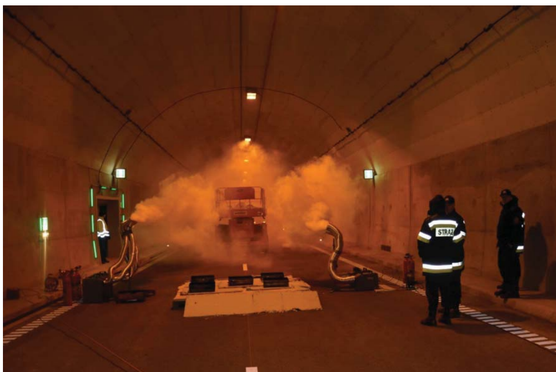
Rys. 1. Dym kierowany w głąb tunelu w kierunku ruchu pojazdów – skuteczne działanie systemu wentylacji wzdłużnej w tunelu drogowym
