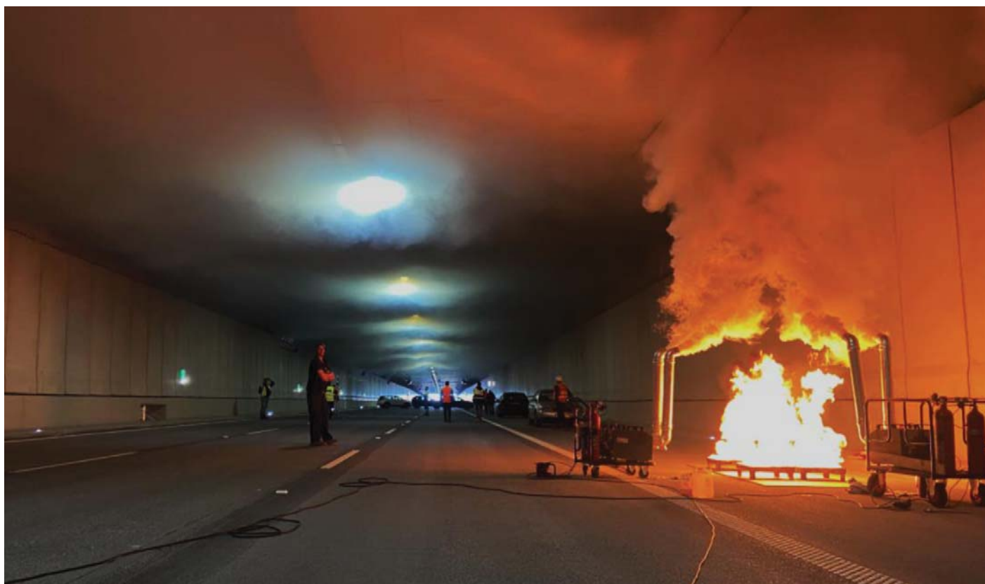
Rys. 2. Warstwa dymu pod stropem tunelu wentylowanego poprzecznie
