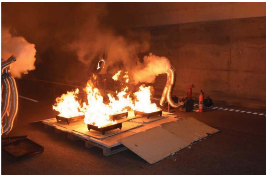
Rys. 3. Źródło gorącego dymu o mocy około 1 MW wykorzystane w próbie z gorącym dymem w tunelu
