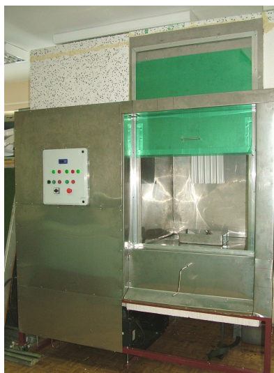
Rys. 2. Prototypowe urządzenie do chłodniczej obróbki żywności w systemie impingement
