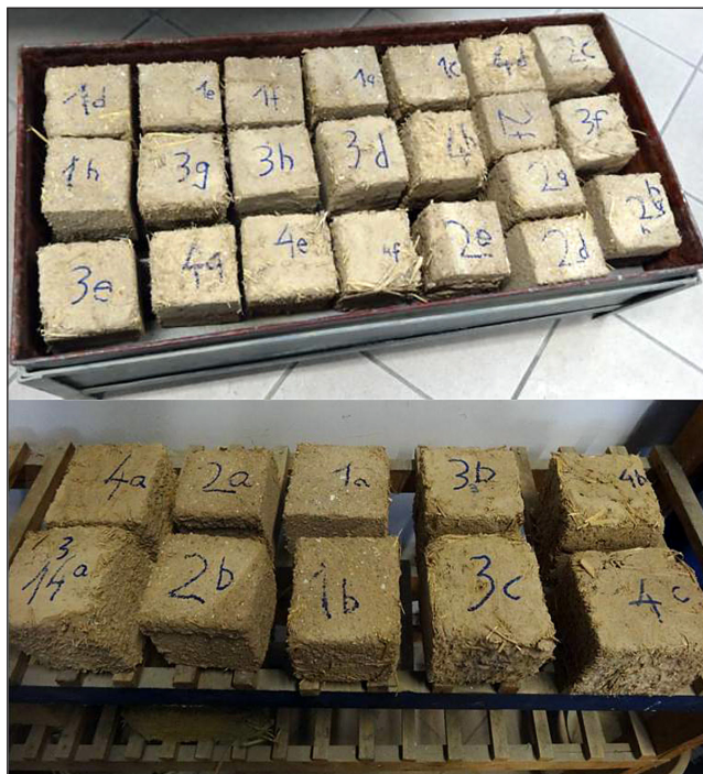
Rys. 2. Próbkę gliny ciężkiej z dodatkiem słomy w warunkach powietrzno-suchych (na górze) oraz po zawilgoceniu do badania mrozoodporności (na dole) (foto. M. Maksymiuk) Fig. 2. Specimens of heavy clay with the addition of straw under air-dry conditions (at the top) and after damp before the frost resistance test (at the bottom) (photo. M. Maksymiuk)
