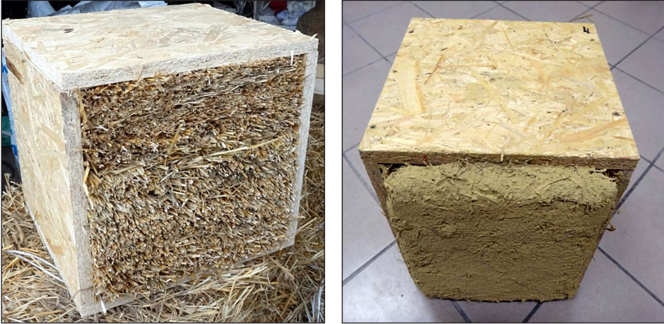
Rys. 1. Panele ze słomy przed (po lewej) i po otynkowaniu gliną z domieszką słomy (po prawej) (foto. M. Maksymiuk)
