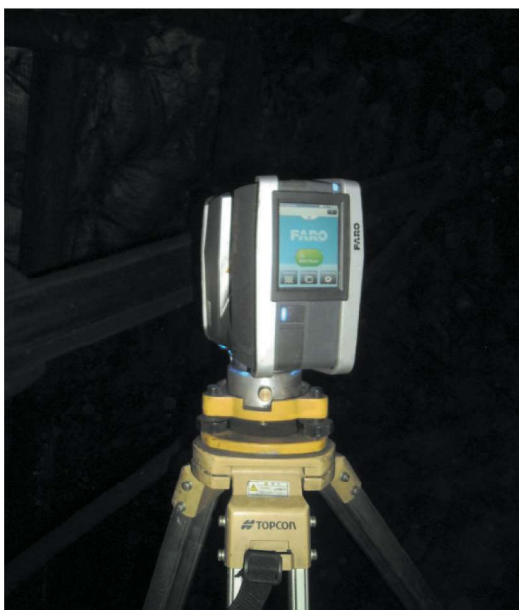
Rys. 6. Skaner 3D firmy FARO w wyrobisku górniczym Fig. 6. 3D scanner by FARO in the mining working
