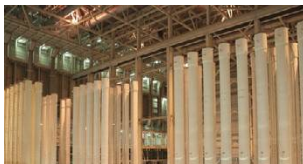
Fot. 4. Kaskada wirówek gazowych w ZWU Piketon w Ohio (USA) [33]
