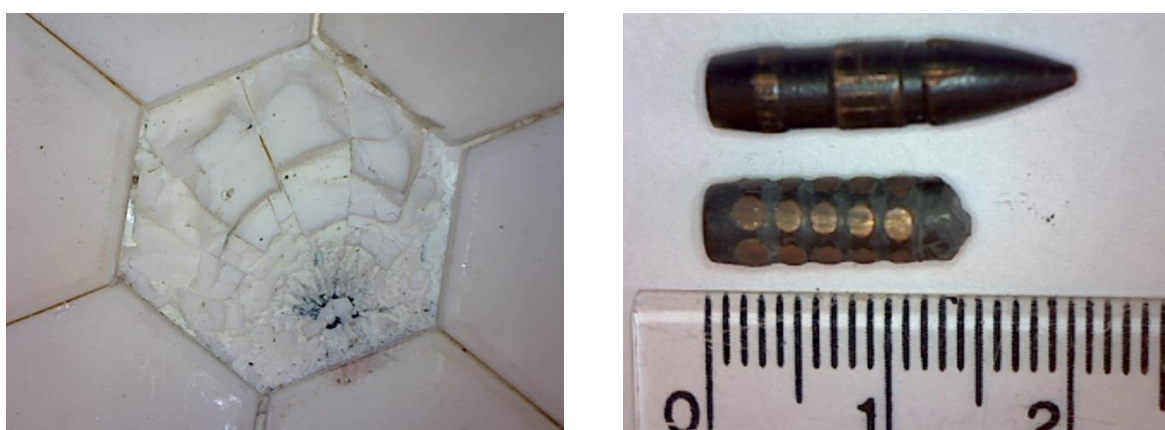
Fot. 1. Zniszczony element pancerza ceramicznego oraz pocisk przeciwpancerny przed i po uderzeniu w pancerz
