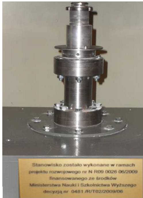
Rys. 1. Stanowisko do badań właściwości zużyciowych materiałów stosowanych na bębny łańcuchowe przenośników zgrzeblowych
