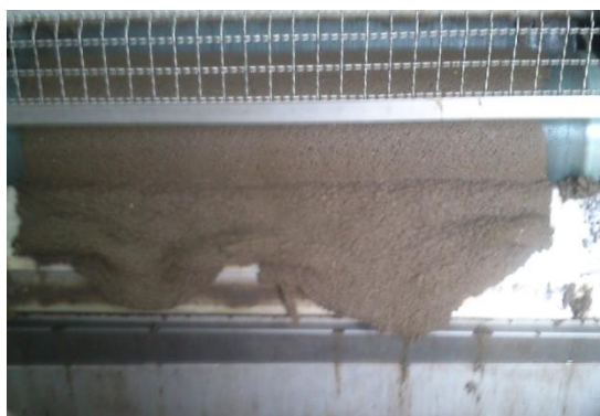
Rys.3.8. Proces odwadniania osadu [6]
