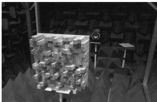
Rys. 2. Pomiar oddziaływania tylnej, płaskiej części dyfuzora (płyty). Pomiar na wysokości wynoszącej 123,4 cm od podłogi komory bezchłowej do dolnej krawędzi dyfuzora. Na fotografii widoczne jest także źródło fali akustycznej (monitor odsłuchowy)
