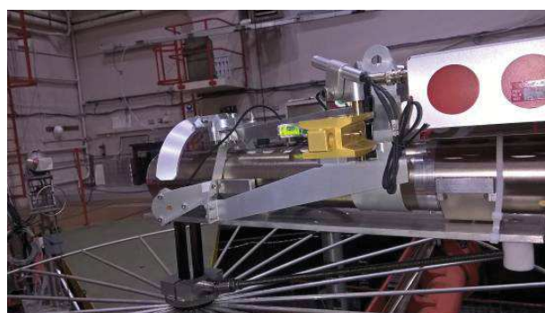
Fot. 7. NG wraz z przymocowanym do niego SDD (na postumencie w kolorze złotym) oraz uchwytem na folie aktywacyjne Phot. 7. The NG with attached SDD (on the top of golden pedestal) and holder for activation foils
