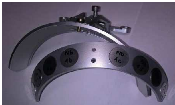
Fot. 8. Uchwyt pozwalający przymocować do generatora w sposób powtarzalny próbki aktywacyjne. W części centralnej dwie folie niobowe oznaczone 1b i 1c Phot. 8. The holder allows reproducibly fasten activation foils to the generator. In the central position are two niobium foils labeled 1b and 1c
