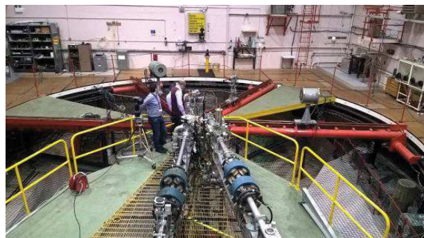
Fot. 6. Wnętrze hali eksperymentalnej. NG umieszczony został w centralnej części hali. Na czerwonych prowadnicach dwa LC i NE-213 Phot. 6. Inside the experimental hall. NG has been fixed in the central position. On the red rails are visible two Long Counters and spectrometer NC-213
