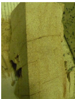
Fig. 4. Mudstone after kilning
