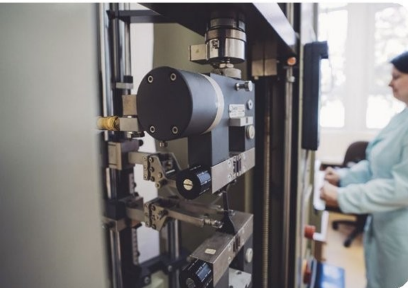
Badanie właściwości wytrzymałościowych przy rozciąganiu
