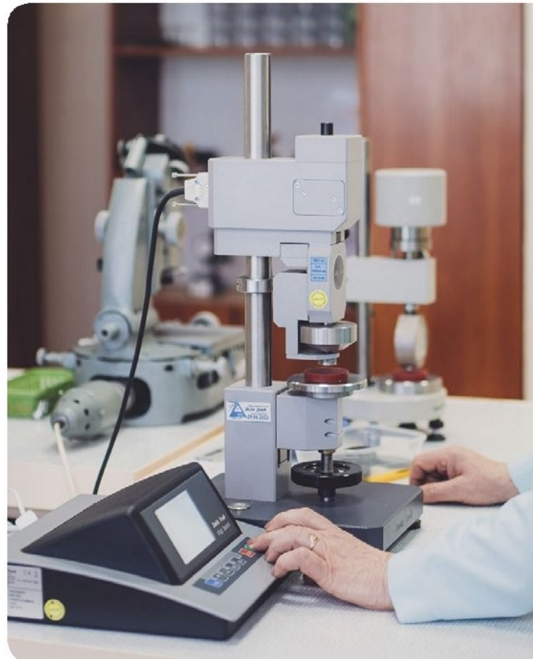
Badanie twardości w skali IRHD
