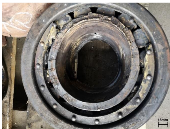
Rys. 11. Odkształcenie łożyska i stopienie pierścienia (źródło: [1])
