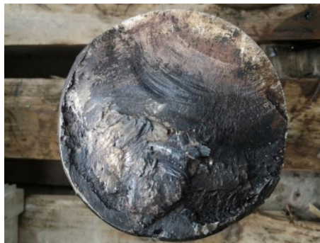
Rys. 5. Widok płaszczyzny przełomu czopa po demontażu łożyskowania (źródło: [1])
