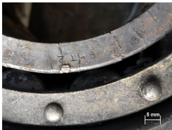
Rys. 12. Odkształcenie plastyczne pierścienia (źródło: [1])
