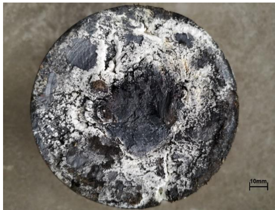
Rys. 13. Przełom ukręconego czopa osi (źródło: [1])
