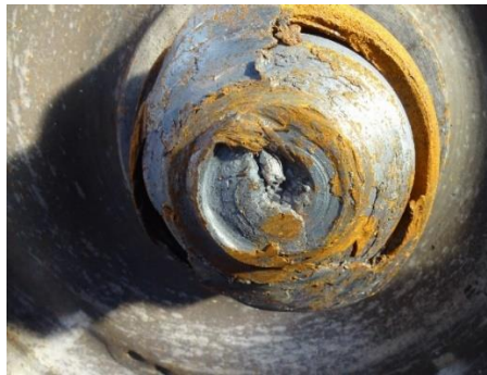
Rys. 4. Skutki kolizji złamanej osi z obudową maźnicy (źródło: [1])
