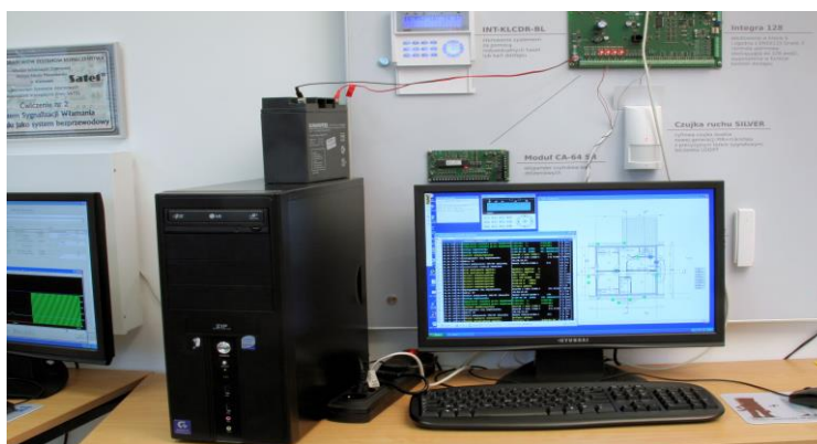
Rys. 4. Stanowisko dydaktyczno-badawcze ESB z nadzorem informatycznym. Widoczna czujka wewnętrzna dualna (SATEL) typu SILVER
