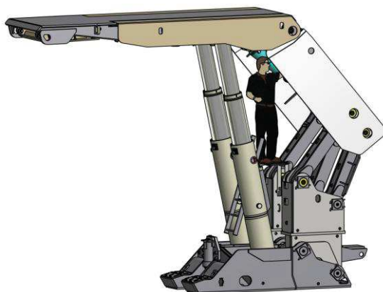
Rys. 17. Model komputerowy sekcji obudowy HYDROMEL-29/46-POz z zamontowanym podestem [6]
