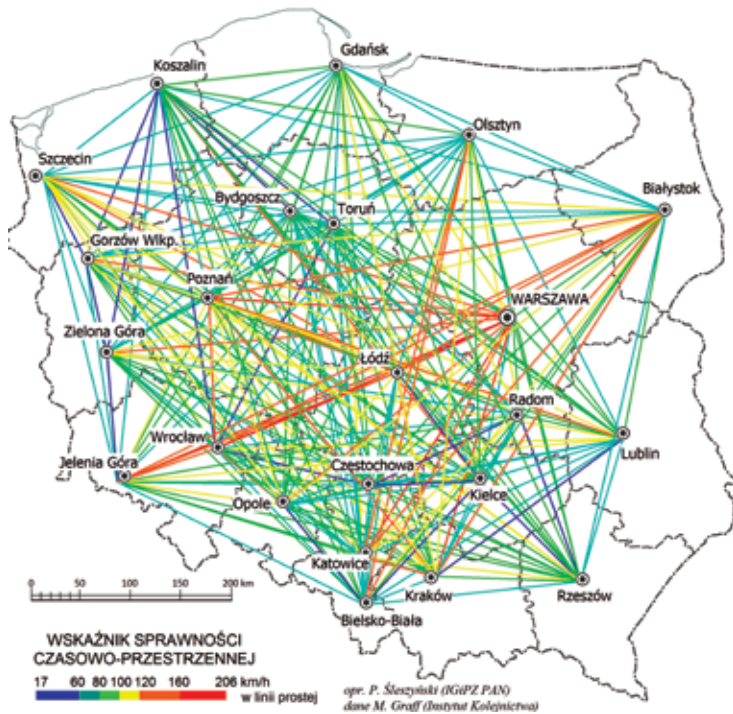
Rys. 3. Skrócenie czasu podróży na sieci kolejowej w wyniku budowy KDP w układzie macierzowym dla analizowanych 10 ośrodków Źródło: na podst. danych Instytutu Kolejnictwa oraz rozkładu jazdy PKP.
