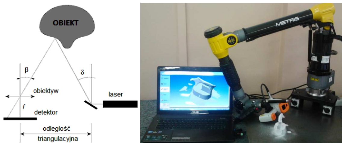
Rys. 5. Zasada pomiaru przy użyciu skanera laserowego wraz ze stanowiskiem pomiarowym
