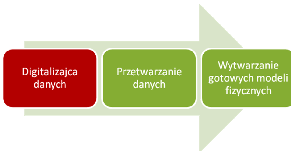
Rys. 1. Etapy inżynierii rekonstrukcyjnej
