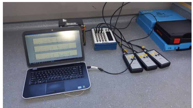
Rys. 11. Układ pomiarowy do badań diagnostycznych napędu z silnikiem indukcyjnym klatkowym
