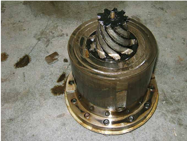
Rys. 16. Uszkodzony zębik przekładni
