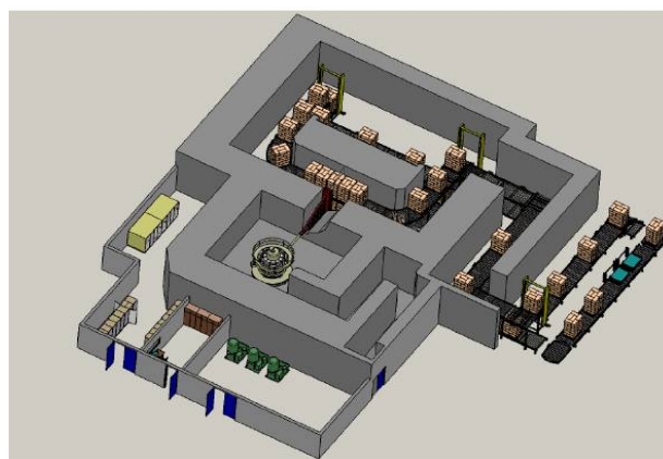
Fot. 6. Makietka instalacji radiacyjnej wykorzystującej akcelerator typu Rhodotron pracujący w reżymie promieniowania hamowania, pracująca w firmie Leoni, Szwajcaria
