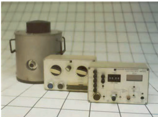
Rys. 3. Tensometryczny przetwornik siły wraz z cyfrowym miernikiem odkształceń
