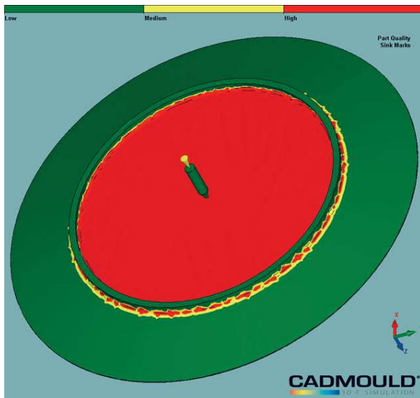
Rys. 6. Graficzne przedstawienie obszarów wypraski z prawdopodobieństwem wystąpienia na nich zapadnięć powierzchni – w odniesieniu do wersji T-1 wypraski Fig. 6. The graphic presentation of sink marks on the injection molding part surface – for the T-1 constructional type
