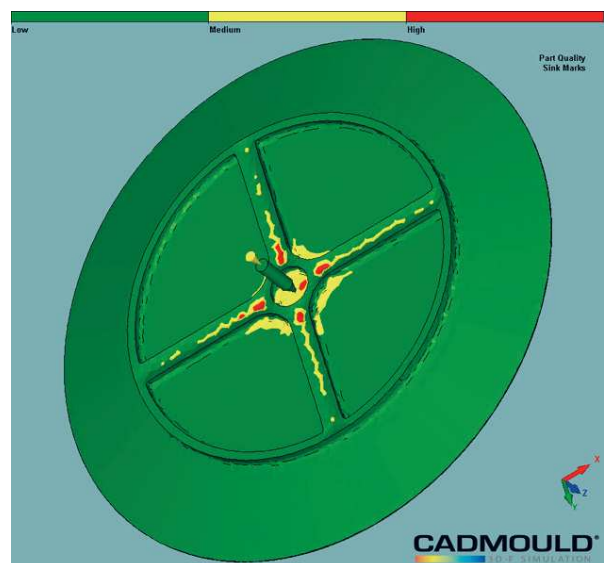
Rys. 8. Graficzne przedstawienie obszarów wypraski z prawdopodobieństwem wystąpienia na nich zapadnięć powierzchni – w odniesieniu do wersji T-3 wypraski Fig. 8. The graphic presentation of sink marks on the injection molding part surface – for the T-3 constructional type
