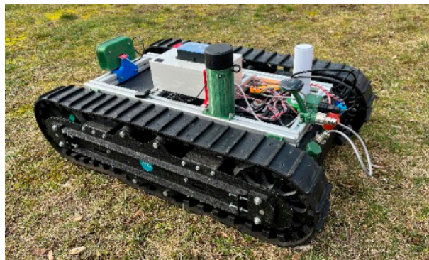
Fot. 2. Bezzałogowy pojazd ze zintegrowaną SIU (fot. CLOR) Photo 2. EU-RADION UGV with integrated SIU (photo CLOR)
