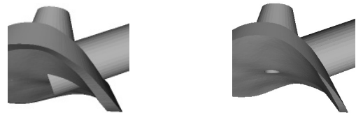
Rys. 14. Fragment bryły narzędzia prowadzącego przed i po operacji odjęcia bryły kości za pomocą różnicy boolowskiej Fig. 14. Fragment of the guiding tool solid before (on left) and after bone solid subtraction by means of Boolean subtraction
