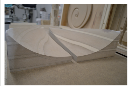
Rys. 14. Dwa kopyta wykonane dla modułu „przejściowego”, który łączy wyrób płaski z niskim rozpraszającym.
