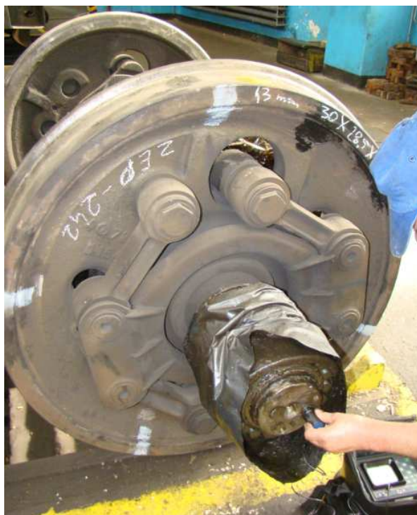
Rys. 6. Defektoskopowa kontrola materiałowa od strony czoła osi lokomotywy manewrowej SM42
