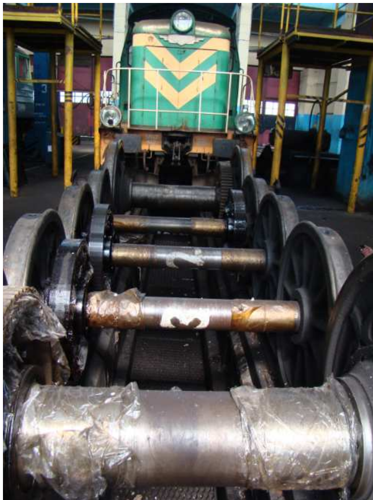
Rys. 1. Zdemontowane osie z uzbrojeniem ze spalinowej lokomotywy manewrowej SM42
