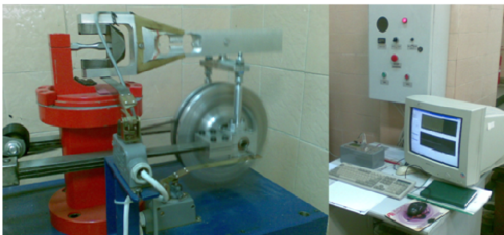
Rys. 2. Stanowisko laboratoryjne do badań zmęczeniowych materiałów
