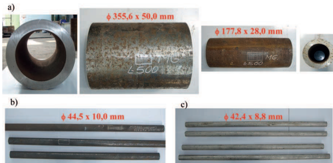
Rys. 1. Materiał do badań w postaci wycinków: a) komór wylotowych przegrzewacza pary ze stali X10CrMoVNb9-1 (P91), b) węzownic przegrzewacza pary III o (ze stali X12CrCoWVNb12-2-2 (VM12SHC), c) węzownic przegrzewacza pary IV o ze stali X10CrNiCuNb18-9-3 (Super 304H)
