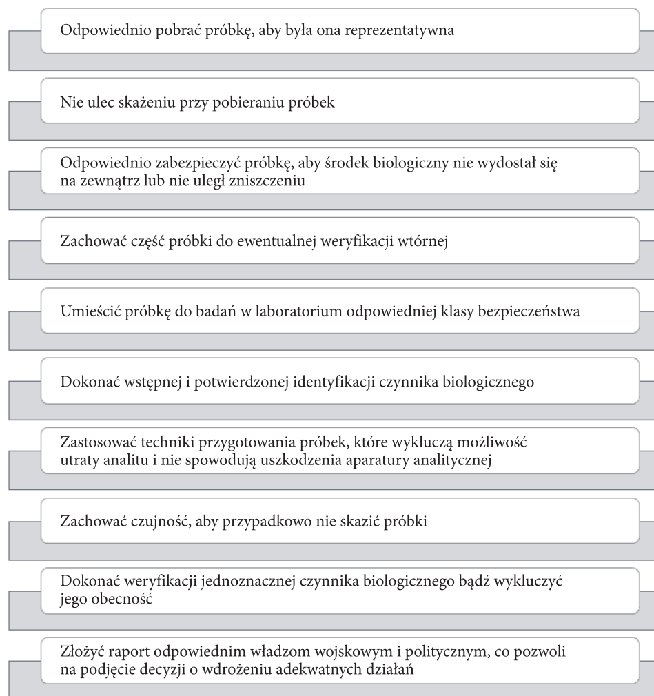
Rys. 33. Schemat postępowania od momentu pobierania próbek do jednoznacznej weryfikacji czynnika biologicznego i opracowania raportu. Opracowanie własne
