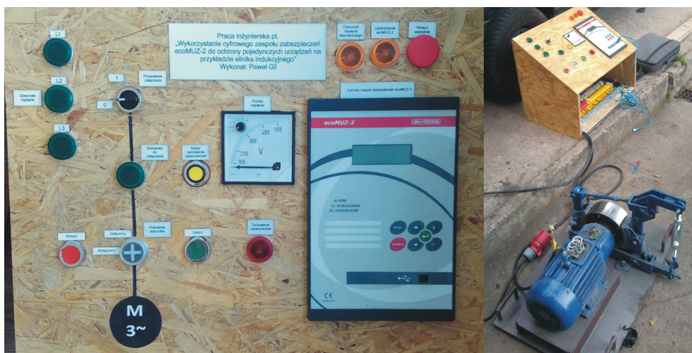
Rys. 2. Panel frontowy stanowiska dydaktycznego (a) i platforma wraz z silnikiem i hamulcem (b). Fig. 2. Front panel of didactic stand (a) and the platform with the motor and brake (b).
