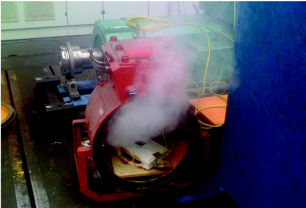
Rys. 6. Ogniwo po badaniach na przeładowanie [3]
